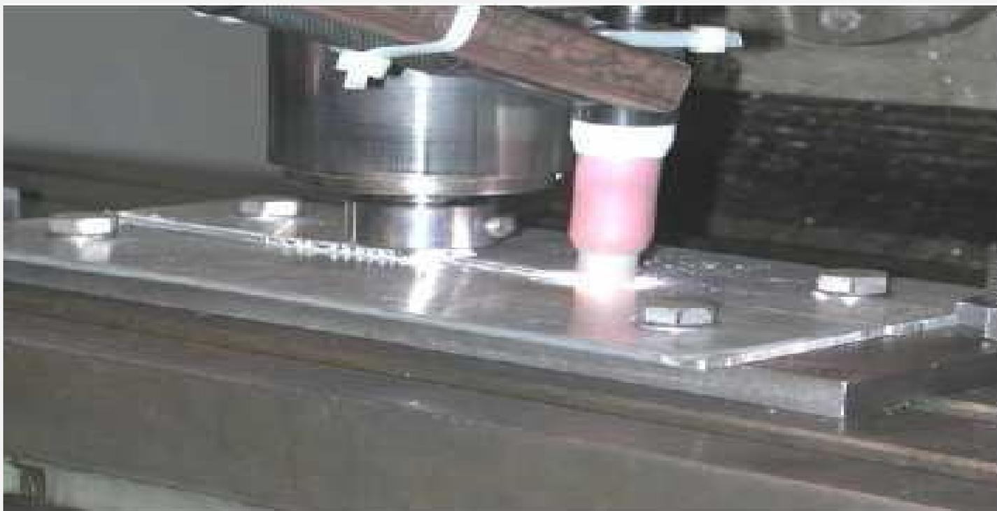
Equipamento SFLH com a utilização de uma fonte de calor TIG
